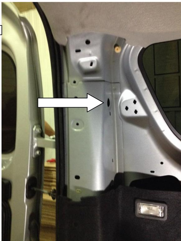
4. Выкрутите из накладки шпильку, и вкрутите ее в то же место в дополнительном фонаре.
