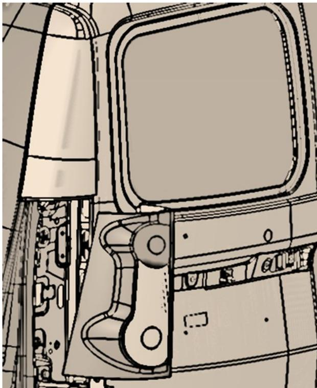
2. После снятия основного фонаря аккуратно снимите внутреннюю обивку задних стоек в салоне.
