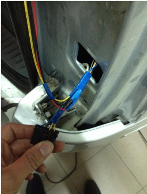
9. Проверить работоспособность дополнительного заднего фонаря, для этого присоедините аккумулятор и включите габаритный огонь и нажмите педаль стоп-сигнала.
