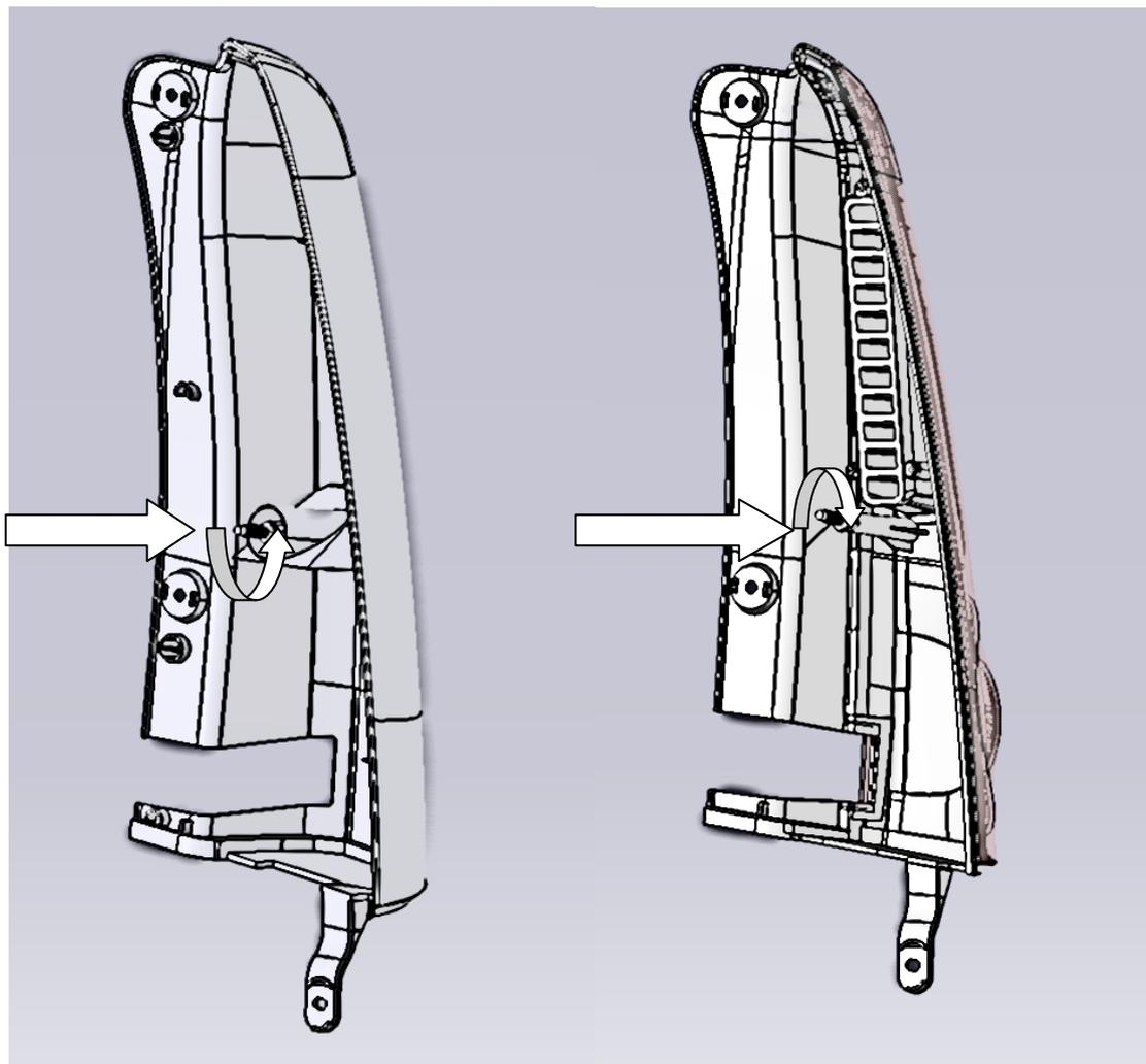
5. Установите дополнительный задний фонарь и закрепите его в штатные места.
