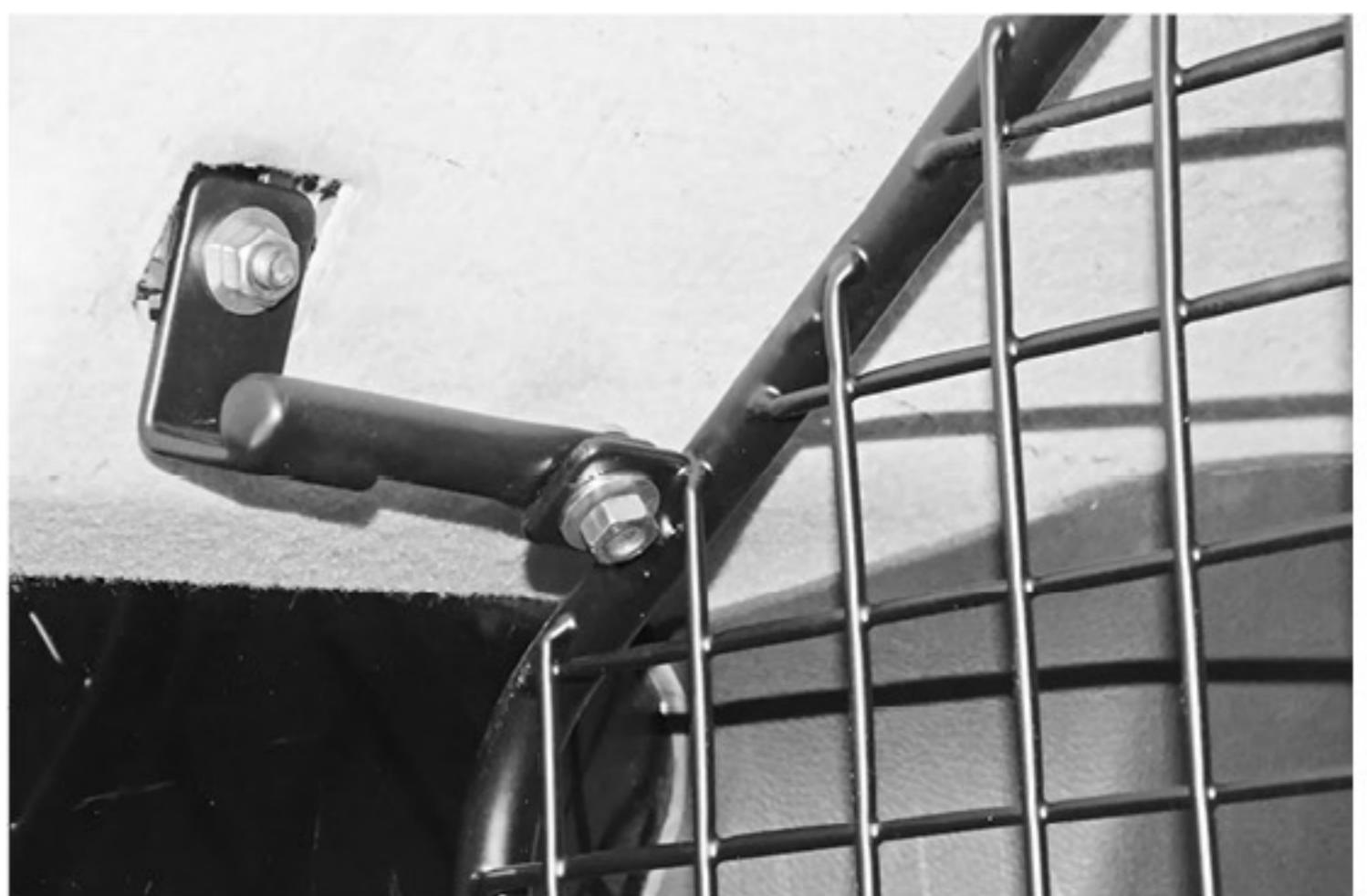
**2.** Для крепления верхних кронштейнов **п.2, 8** снимем заглушки на обивке потолка и освободим штатные отверстия. Кронштейны закрепим **закладными болтами и гайками M8 с шайбами.**
