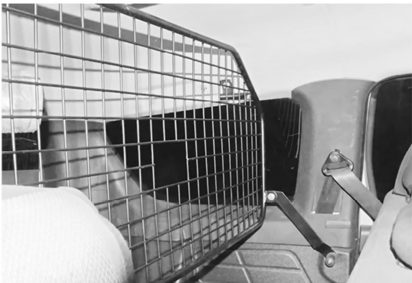
**3.** Для крепления нижних кронштейнов снимем с фиксатора и откинем вперед спинку заднего кресла. Выкрутим фиксаторы и, используя их как крепежные болты, закрепим свободные концы нижних кронштейнов на кузове .
