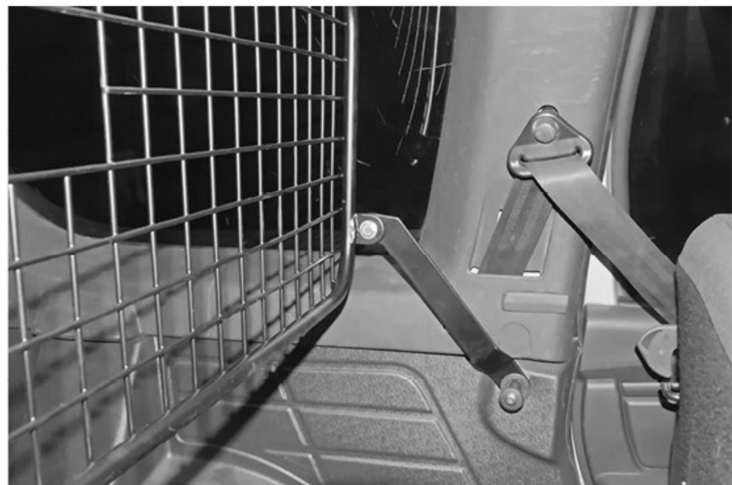
**5.** После монтажа сетки **п.5** придаем ей вертикальное положение и протягиваем крепеж.
